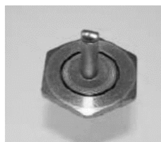
Рис. 7 Насадка для предотвращения перетягивания заклепки
