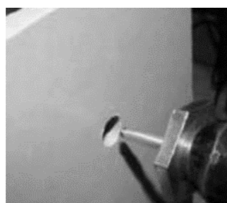
Рис. 8 Насадка установленная на заклепочник
