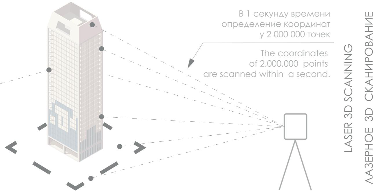
ЛАЗЕРНОЕ 3Д СКАНИРОВАНИЕ
